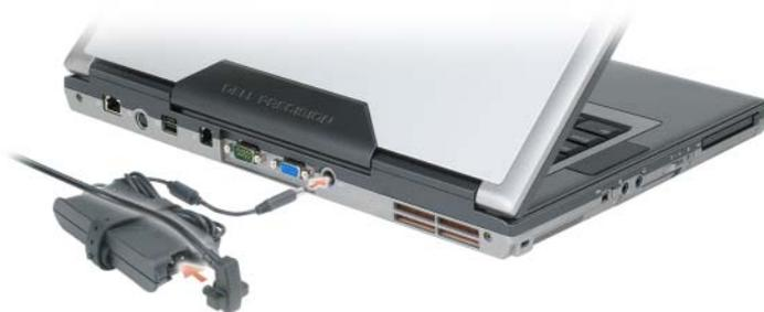
Адаптер преобразует напряжение переменного тока в напряжение постоянного тока, необходимое для питания компьютера. Адаптер переменного тока можно подключать как к включенному, так и к выключенному компьютеру.
