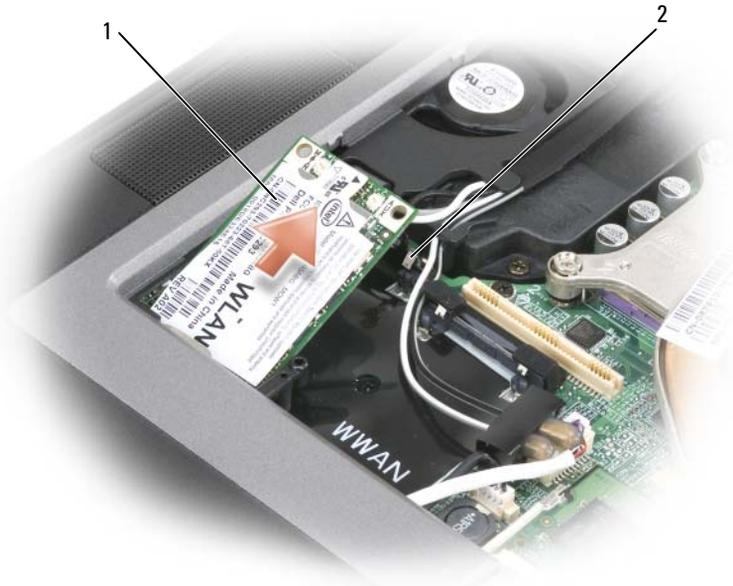
1 плата беспроводной локальной сети (WLAN) 2 металлическая скоба
